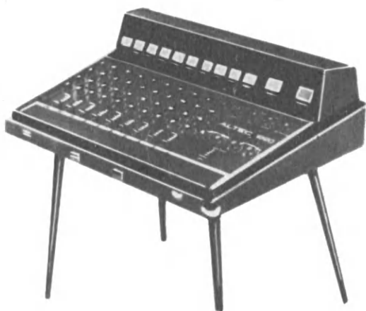
Рис. 101. Микшерный пульт типа 1220 фирмы "Altec" имеет 11 каналов, из которых 10 микрофонных, ревербератор, многополосный регулятор тембра и контроль уровня каждого канала
