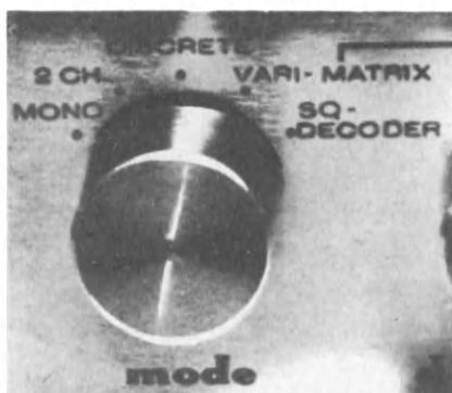
Рис. 151. В квадрафонических устройствах переключатель "Моно"—"Сtereo" имеет новые функции: а — в квадраусилителе "Marantz 4270"; б — в квадраусилителе "Grundig RTV 1040"
